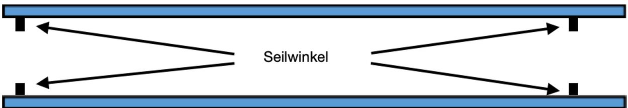
2. Als nächstes ziehen Sie das Edelstahl-Seil durch die vorderen Seilwinkel. Danach ziehen Sie das Markisenlaken durch die Ösen links und rechts im Laken auf das Seil auf. Das Laken muss so aufgezogen werden, das die mittig gesetzte Öse im Laken nach vorne zeigt.
